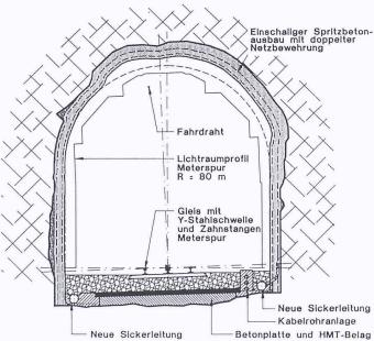
Bild 4 Aufbau der Tunnelquerschnitte alt und
