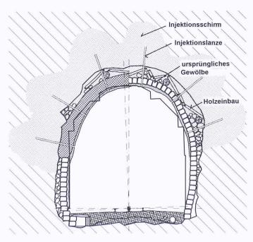
Bild 5. Injektionsschema: Über Injektionslanzen wird Polyurethan in die Hohlräume injiziert. Der punktierte Raster zeigt den erzielten Iniektionsschirm zur Gebirgsverfestigung
