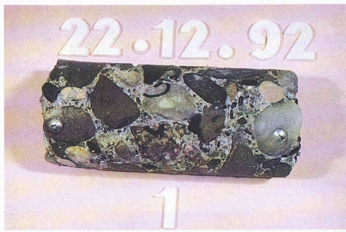
Bild 12. Betonprobekörper HOZ L-NW/HS 70% + Verflüssiger, nach 111 Wochen Sulfatlagerung mit starker Oberflächenerosion
