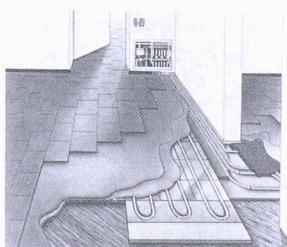
(Dämmung und Lastverteilsschicht inbegriffen) fügt sich Stramax R25 in jede denkbare Bausituation und trägt zur Substanzerhaltung bei: Kostspielige Türlichtkorrekturen oder die Anpassung der Treppenhöhe werden hinfällig.
