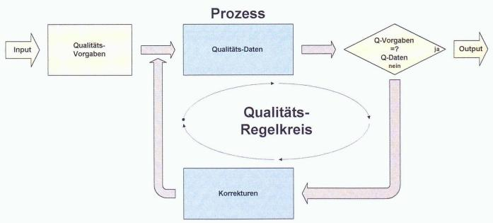
Bild 5. Elementarer Qualitäts-Regelkreis als Baustein eines Qualitätssicherungs-Systems
