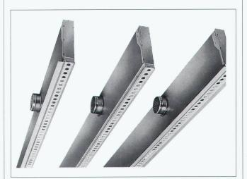
Wenn die neue Düsenschiene Typ DS1 erst einmal eingebaut ist, gibt es nicht mehr viel zu sehen. Sie lässt sich harmonisch in die Decke integrieren. Typische Anwendungen sind Zuluftanlagen mit konstantem oder variablem Volumenstrom für Büros, Schulungsräume, Labors, Schalterhallen und ähnliches. Die schwenkbaren Düsen verteilen gleichmässig die Frischluft im Raum.
