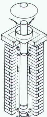
Diese einzigartige, temperatur- und säurebeständige Spezialdichtung ist das unverwechselbare Kennzeichen unseres Supra-Systems. Zum unverwüstlichen Edelstahl kommt die Dichtigkeit des Gesamtsystems. Perfekter Schutz gegen Kondensat in Kesselanlagen mit Brennwertbetrieb oder besonders niedrigen Abgastemperaturen.
