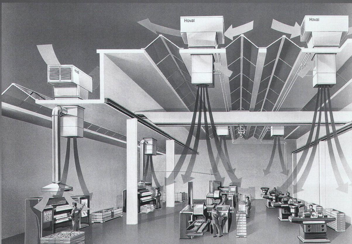
Frische Luft gezielt am Arbeitsplatz – verbrauchte Luft sicher abgeführt – energiesparende Wärmerückgewinnung zum Aufheizen der kalten Frischluft im Winter. Das sind die überzeugenden Vorteile des Hoval LHW-Systems zum Heizen und Lüften von Hallen und grossen Räumen.
