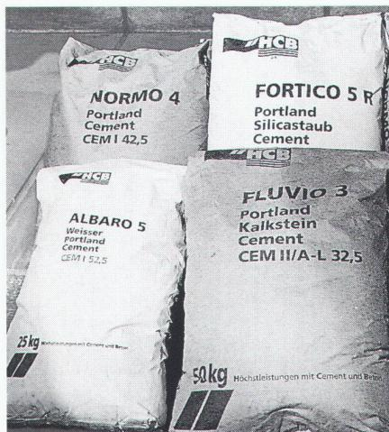
stein entsteht ein SIA-genormter Portlandkalksteinzement CEM II/A-L 32,5, der sich in allen gängigen Betonanwendungen sehr gut verarbeiten lässt.
