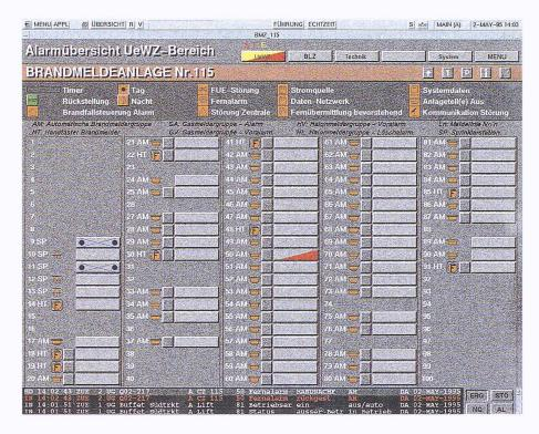
ob die Anlagen oder Anlageteile nach Abschluss von Reparatur- oder Unterhaltsarbeiten wieder scharf geschaltet sind. Dazu dienen die Anlageübersichtsbilder und die Zeitüberwachungsfunktionen. Beispielsweise erzeugen ausgeschaltete Melder nach Ablauf einer einstellbaren Zeit eine Alarmmeldung.
