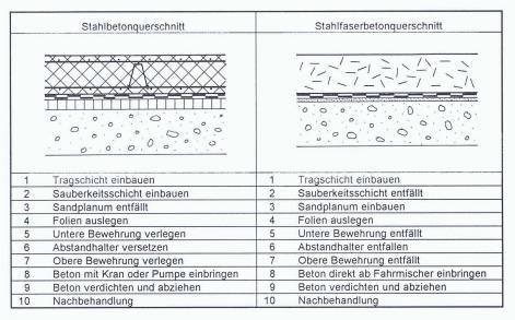
Bild 1. Aufbau und Arbeitsschritte im Vergleich Stahlbeton/Stahlfaserbeton
