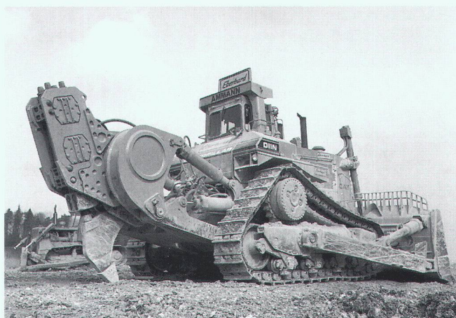
Unser 100-Tonner CAT D 11 N meistert jeden Felsabbau leicht, souverän, schnell und setzt Massstäbe im rationellen Felsabbau.
