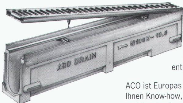
Die Rinnenkörper aus Polymerbeton sind vergleichsweise leicht, extrem zäh und von hoher Festigkeit. Silikatgestein als Füllstoff und Reaktionsharz als Bindemittel machen das Material glattwandig, frost-, tausatz- und korrosionsbeständig. Ein idealer Werkstoff für den Tiefbau, der auch umweltgerecht entsorgt werden kann.
