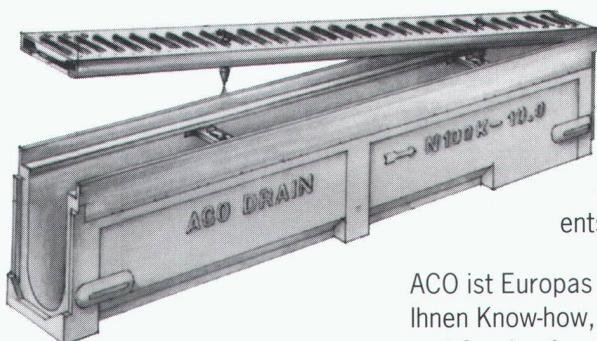
Die Rinnenkörper aus Polymerbeton sind vergleichsweise leicht, extrem zäh und von hoher Festigkeit. Silikatgestein als Füllstoff und Reaktionsharz als Bindemittel machen das Material glattwandig, frost-, tausalz- und korrosionsbeständig. Ein idealer Werkstoff für den Tiefbau, der auch umweltgerecht entsorgt werden kann.
