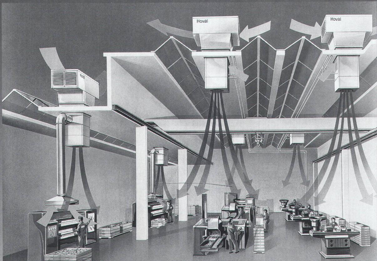
Frische Luft gezielt am Arbeitsplatz – verbrauchte Luft sicher abgeführt – energiesparende Wärmerückgewinnung zum Aufheizen der kalten Frischluft im Winter. Das sind die überzeugenden Vorteile des Hoval LWH-Systems zum Heizen und Lüften von Hallen und grossen Räumen.
