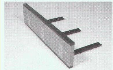
EgcoISO Das einbaufertige, isolierende Decken-Stirnabschaltungs- und -Trennelement in praktischer 1-Meter-Länge; mit Mineralwollplatte • brandsicher • optimale Wärme- und Schalldämmung • kein zusätzlicher Schallmaterial- und Verlege-Aufwand • kürzeste Verlegezeit • gleichzeitiges Betonieren von zwei getrennten Bauteilen.
