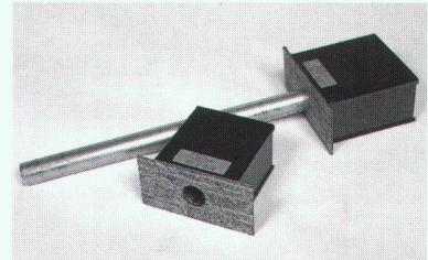
**EgcoTritt** die EMPA-geprüfte einfache, sichere und wirtschaftliche **Trittschallisolation inkl. Brand- schutz** verbessert den Schalldämmwert  $\Delta L_w$  um 30 dB: als Auflager für Treppenpodeste, Laubengänge, abgestützte Balkone usw. • korrosionssicherer Qualitäts-Dorn • Armierungs- bügel mit erhöhtem Durchstanzwiderstand • die Innovation
