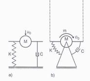
Bild 7. Feder-Dämpfer-Massen-Modell mit einem internen Freiheitsgrad
