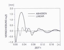
Bild 16. Vertikale Verschiebung im Schwerpunkt des Ambosses
