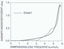
Bild 2. Vertikale dynamische Steifiakeit des Fundamentes auf der Oberfläche der homogenen Schicht
