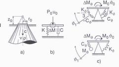
Bild 6. Feder-Dämpfer-Massen-Modell ohne internen Freiheitsgrad für a) Translation b) Rotation
