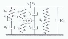
Bild 11. Feder-Dämpfer-Massen-Modell mit zwei internen Freiheitsgraden
