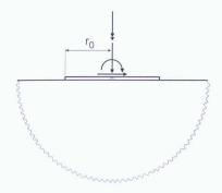
Bild 4. Kreisförmiges Fundament auf die Oberfläche des homogenen Halbraumes
