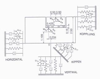
Bild 15. Dynamisches Modell der Schmiedehammerfundation mit Feder-Dämpfer-Massen-Modell
