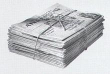
Die neuen HOMATHERM® Dämmplatten aus Zellulose sind durch und durch ökologisch – von den Rohstoffen über die Herstellung, Verarbeitung und Distribution bis hin zum Recycling. Schon als Rohstoff bringt Zeitungspapier die natürlichen Voraussetzungen zur Wärmedämmung mit: Die darin enthaltenen Poren schließen Luft ein, die Wärmeverluste verhindert.
