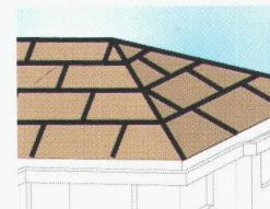
**2** Wasserdicht gemäss Norm SIA 238. Plattenstösse und Anschlüsse mit PAVATEX-Selbstklebeband 13cm abgedichtet.
