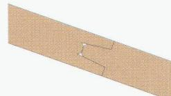
Extra entwickelte, auf das Plattenmaterial abgestimmte Steckverbindung. Für die sparrenunabhängige Verlegung.
