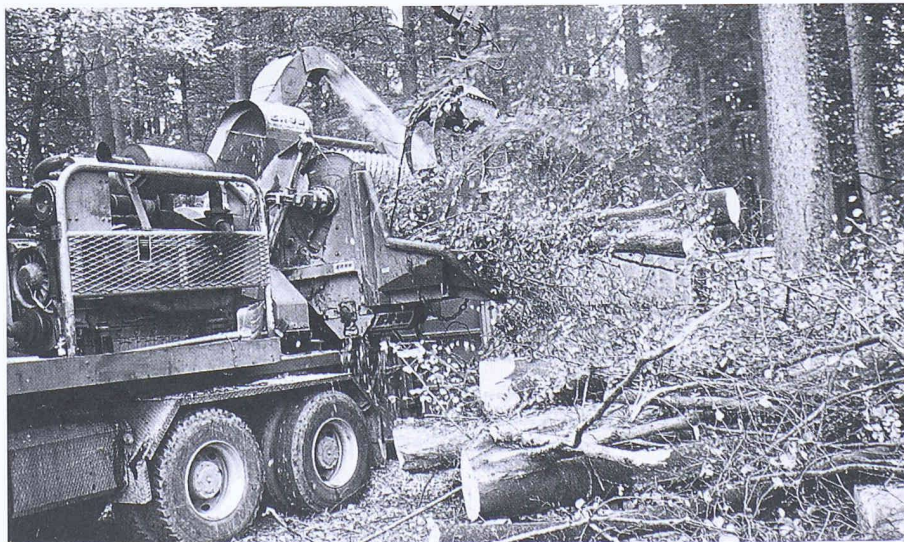
Heute kann Abfallholz direkt im Wald zu Holzschnitzeln verarbeitet werden (Bild: Comet)
