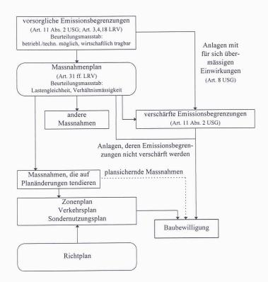
Ablaufschema zur Ermittlung der Bauvoraussetzungen
