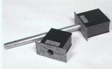
**EgcoTRITT** die EMPA-geprüfte einfache, sichere und wirtschaftliche **Trittschallisolations inkl. Brand-schutz** verbessert den Schalldämmwert  $\Delta L_w$  um 30 dB: als Auflager für Treppenpodeste, Laubengänge, abgestützte Balkone usw. • korrosionssicherer Qualitäts-Dorn • Armierungsbügel mit erhöhtem Durchstanzwiderstand • die Innovation
