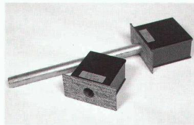
**EgcoTritt** die EMPA-geprüfte einfache, sichere und wirtschaftliche Trittschallisolierung inkl. Brand-schutz verbessert den Schalldämmwert  $\Delta L_w$  um 30 dB: als Auflager für Treppenpodeste, Laubengänge, abgestützte Balkone usw. • korrosionssicherer Qualitäts-Dorn • Armierungs-bügel mit erhöhtem Durchstanzwiderstand • die Innovation.
