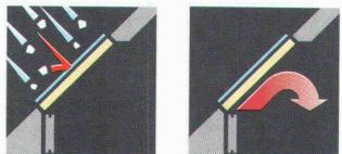
VELUX THERMO-STAR Isolierglasscheiben sind gasgefüllt, zweifach versiegelt und haben einen K-Wert von 1,3 W/m<sup>2</sup>K. Das innere Glas ist mit einer Edelmetallbeschichtung versehen. Das äußere Glas (ESG) ist gehärtet und bietet einen 99 prozentigen Hagelschutz.
