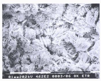
Bild 4. Ettringit in den Poren bei Mischung Nr. 8
