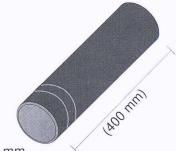
Ø 100 mm Bild 1. Probezylinder
