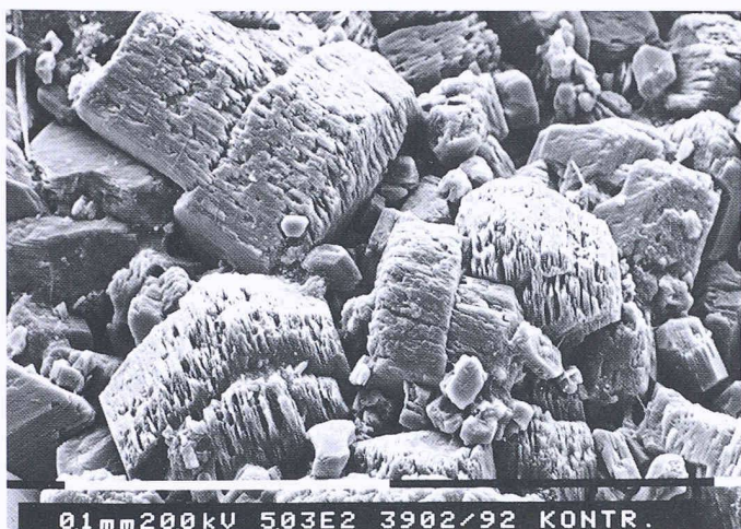
Bild 3. Gipskristalle im korrodierten Zementstein, Vergrößerung: ca. 500 x, REM-Labor Universität Basel
