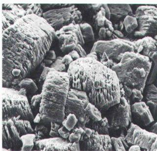
**Zum Titelbild: Betonkorrosion in Abwasserreinigungsanlagen**
