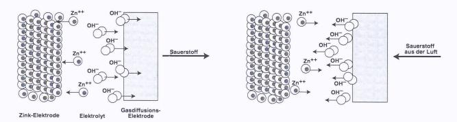
Prinzip der wiederaufladbaren Zink/Luft-Batterie: laden und entladen
