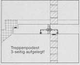
Wärme- und trittschallgedämmte Deckenseparationen: z.B. Treppenpodeste
