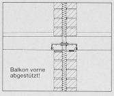
Wärmegedämmte Balkonplatte auf Stützen
