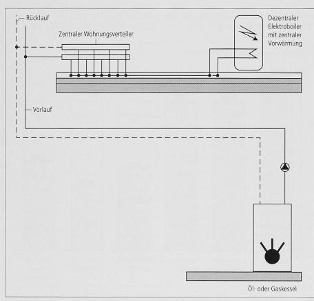
Bild 3. Schematische Darstellung der Anlage nur mit Heizkessel
