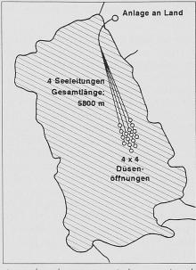
Ausgehend von einer Anlage an Land, in der ein Kompressor mit Windkessel installiert ist, wird während der Wintermonate Luft durch vier Kunststoffleitungen zum tiefsten Punkt des Sees geführt.
