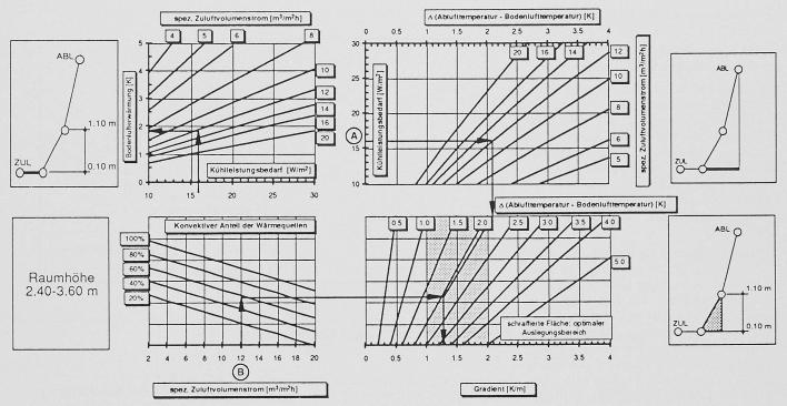
Bild 2. ERL-Dimensionierungsnomogramm für die Auslegung von Quellüftungen. Schraffierter Bereich = optimaler Auslegungsbereich unter Einhaltung des thermischen Komforts
