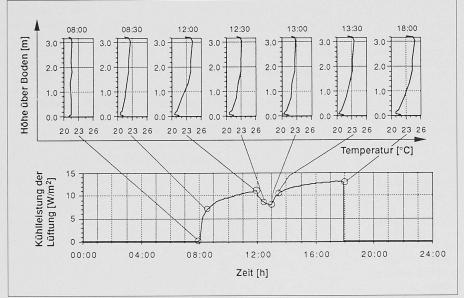
Bild 3. Entwicklung des Temperaturprofils im Verlauf des Tages bei konstanten internen Lasten und einer einstündigen Mittagspause ohne interne Lasten, aber mit eingeschalteter Lüftung (Messung SCS)
