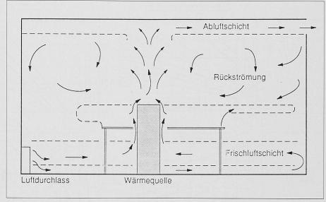
Bild 1. Raumströmung beim Quelluftprinzip
