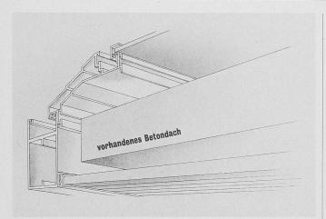
Das massgenau vorgefertigte Überschub-Vordach wird einfach über das vorhandene Betondach geschoben und mit Stahlkonsolen unsichtbar im Mauerwerk verankert
