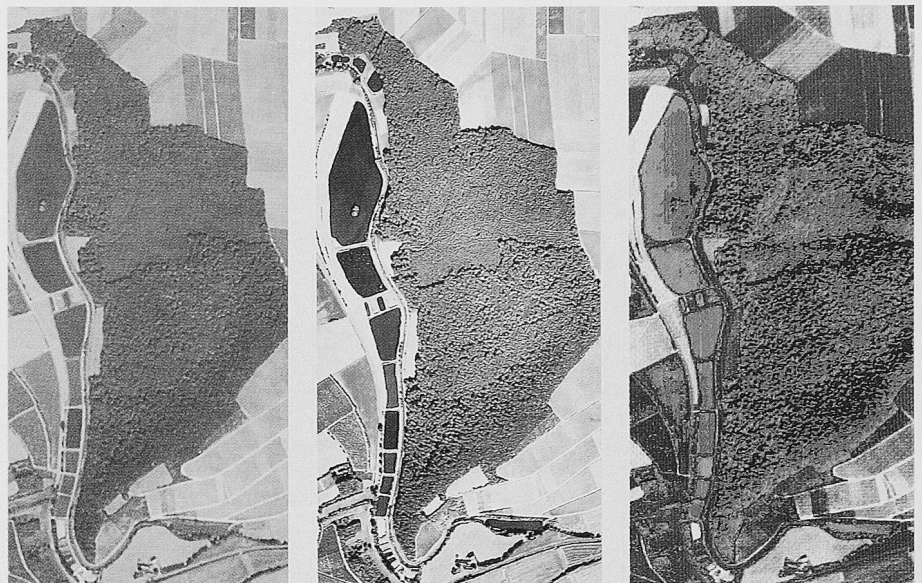
Bild 3. Bei dieser Luftaufnahme sind links am Waldrand Fischteiche zu erkennen. Während auf einem normalen Foto (links) und einer Infrarot-Aufnahme (Mitte) kaum eine Unterscheidung der Wasserfarben zu erkennen ist, macht das CASI-Bild nach einer Verarbeitung der Daten der Spectral-Anstrahlung der Wasseroberfläche deutlich. Eine genaue Interpretation der Farbdaten erfordert jedoch gleichzeitig auch eine Grundanalyse der Stoffe in den Teichen
