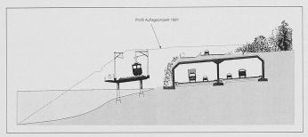
Bild 4. Schnitt durch den neuen Tagbautunnel «Spier»; Blick Richtung Süden. Über den Tunnel kommt die Kantonsstrasse und ein Rad- und Gehweg zu liegen. Die auf zwei Spuren ausgebaute Linie der SBB/LSE-Strecke zwischen Luzern und Hergiswil kommt im Bereich des Vierwaldstättesees auf eine neue Brücke zu liegen
