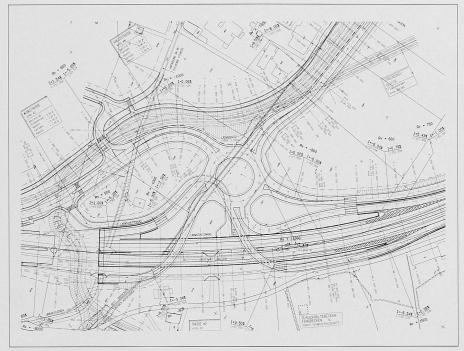
Bild 3. Der neue Autobahnanschluss Luzern–Horw wird erstmals in der Schweiz als Kreiselbauwerk ausgebildet. Neben den vier Anschlussspuren laufen auch die drei Zubringerstrassen beim Kreisel «Schlund» zusammen. Der abgebildete Plan wurde, wie das gesamte Erweiterungsprojekt, mit dem CAD-Programm STRATIS konstruiert und gestaltet
