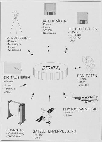
Bild 6. Datenfluss im Strassen- und Tiefbausystem STRATIS
