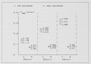
Bild 6. Grafische Darstellung der Mittelwerte gemäss Tabellen 2 und 3 und Streubereiche der Effektivwerte der Schwinggeschwindigkeitsamplituden V<sub>RMS,R</sub> der Immissionen des Messzuges bei verschiedenen Geschwindigkeiten (Austrasse 29, Fahrrichtung Innerstadt)
