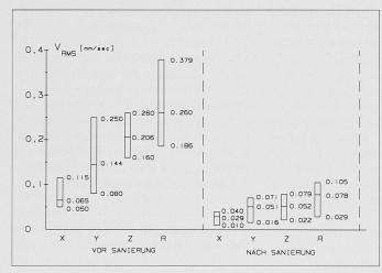
Bild 5. Grafische Darstellung der Mittelwerte und Streubereiche der Effektivwerte der Schwinggeschwindigkeitsamplituden V<sub>RMS</sub> der Immissionen von Kursfahrzeugen (Austrasse 29, Fahrrichtung Innerstadt) gemäss Tabelle 1
