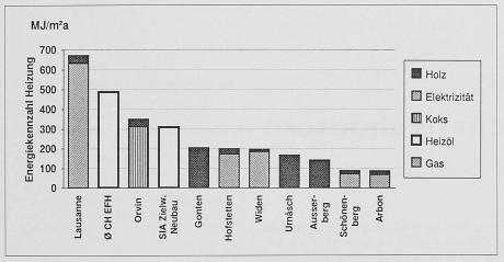
Bild 1. Energiekennzahl-Heizung der untersuchten Sonnenenergiehäuser
