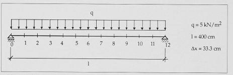
Bild 4. Einfeldträger unter gleichmässig verteilter Belastung
