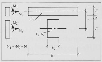
Bild 2. Querschnitt mit Fuge
