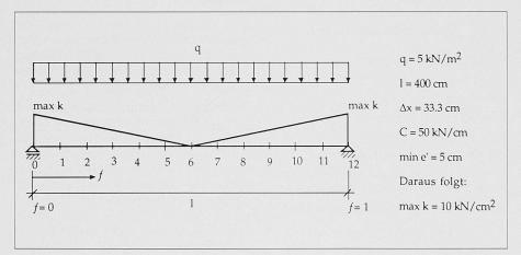
Bild 8. Einfeldträger unter gleichmässig verteilter Belastung mit veränderlicher Schubsteifigkeit
