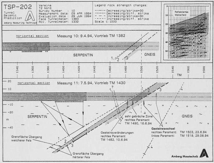
Bild 7. Seismische Vorauserkundung, die bei Tm rd. 1510 den Wechsel vom Serpentinit zum Dorfbergkristallin anzeigt. Stand der Vortriebsarbeiten: Tm 1382
