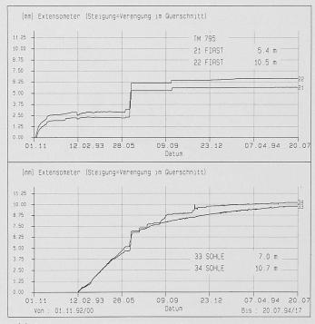
Bild 3. Messung: Extensometer (Steigung = Verengung im Querschnitt)
