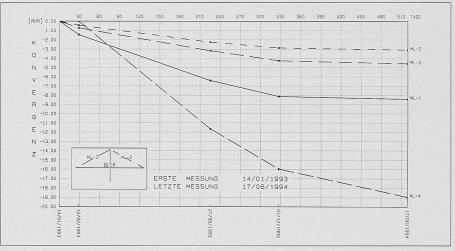
Bild 4. Messung: Distometer-Konvergenz (ansteigend = Erweiterung, abfallend = Verengung)
