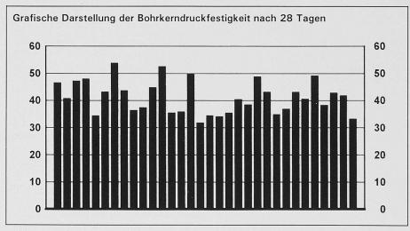
Bild 1. Grafische Darstellung von Bohrkerndruckfestigkeit nach 28 Tagen
