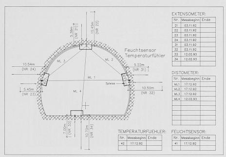
Bild 1. Messquerschnitt TM 795 im Vereinatunnel mit Blickrichtung Vortrieb
