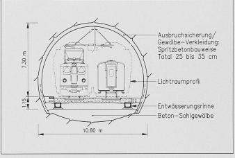
Bild 4. Normalprofil Zweispurtunnel im Flysch
