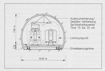
Bild 5. Normalprofil Zweispurtunnel im Serpentin
