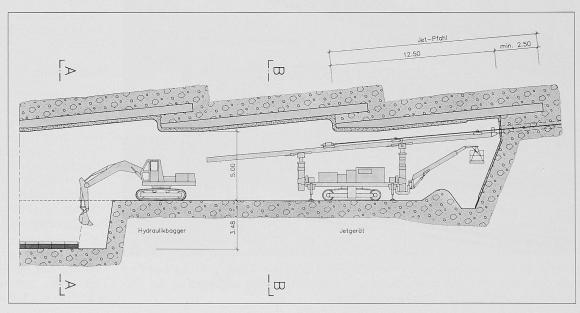
Bild 1. Ausbruchsvorgang in den Lockermaterialstrecken des Zugwald-Tunnels, Längsschnitt
