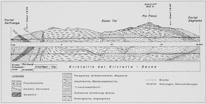
Bild 2. Geologie Vereinatunnel; Profil und Horizontalschnitt
