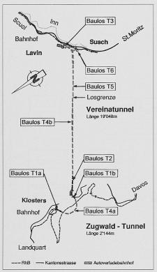
Bild 3. Loseinteilung für den Bau der Vereinalinie
