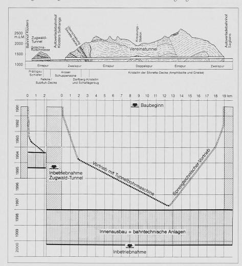
Bild 1. Längenprofil der Vereinalinie mit Bauprogramm
