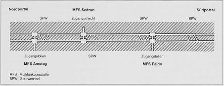
Bild 3. Räume im Gotthardbasistunnel
