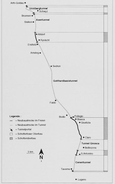
Bild 2. Übersicht über die Bereiche mit Schotteroberbau bzw. schotterlosem Oberbau der Neubaustrecke Gotthard (Basisvariante)
