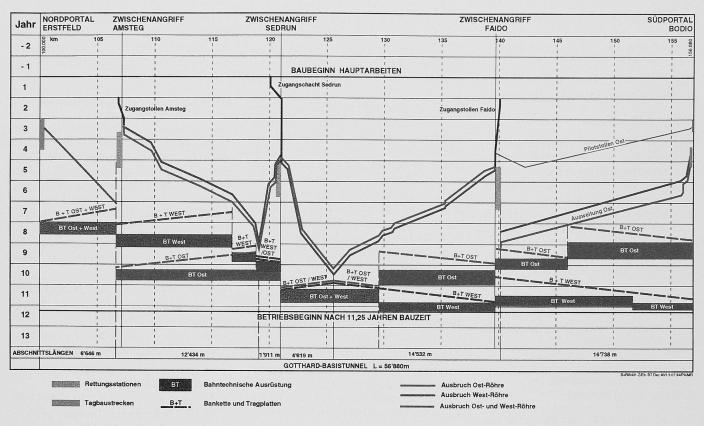
Bild 4. Vereinfachtes Bauprogramm Gotthardbasistunnel
