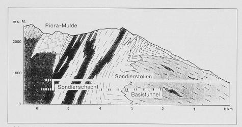
Bild 4. Sondiersystem Pioramulde, Längenprofil
