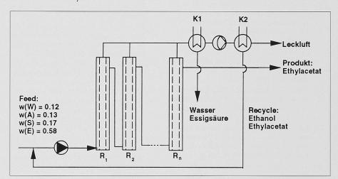
Bild 10. Fliessbild der Rohrreaktorschaltung von Membranreaktoren (R: Membranreaktor, P: Pumpe, K: Kondensator)
