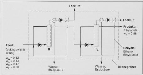
Bild 9. Fliessbild der Kaskadenschaltung von Schlaufenmembranreaktoren (R: Membranreaktor)
