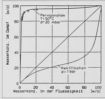
Bild 5. Vergleich der destillativen und pervaporativen Ethanol-Wasser-Trennung im McCabe-Thiele-Diagramm [25]
