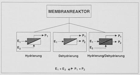
Bild 2. Varianten der Stromführung bei Membranreaktoren
