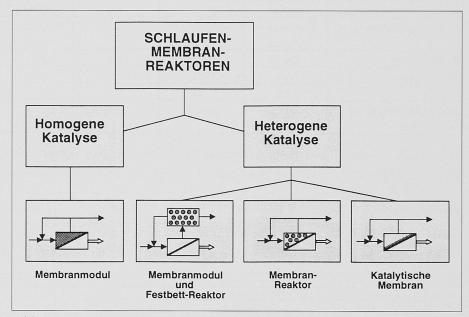
Bild 3. Homogene und heterogene Katalyse bei Membranreaktoren
