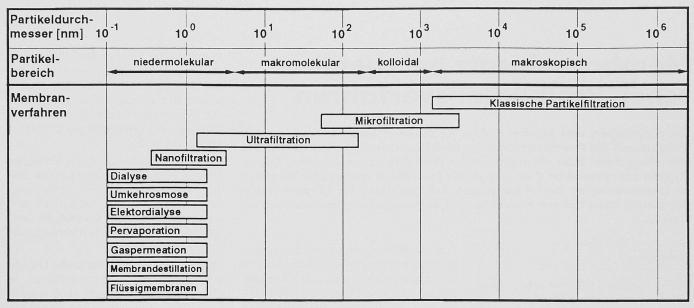
Bild 1. Einsatzbereiche technischer Membranprozesse [5, 7]
