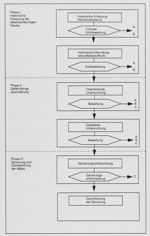
Bild 1. Vereinfachtes Schema für die Altlastenbearbeitung in Sachsen-Anhalt
