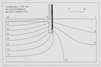
Bild 1. Vorausberechnete Isothermen für das Heizperiodenmittel im Sockelbereich. Die Gleichgewichtstemperatur von 10°C wurde zu tief eingschätzt. Gemessen wurden später 12°C
