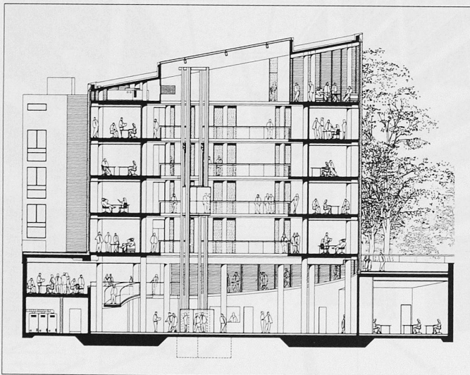
Oben: Querschnitt mit Rundhof und Lifanlage
