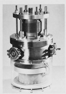
Anwendung: Supraleitend gelagertes Schwungrad zur Energiespeicherung
