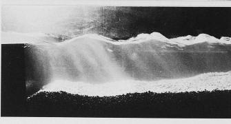
Bild 5. oben: Tauchstrahl, unten: Wellstrahl, von der Seite gesehen
