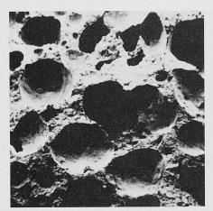
Porenstruktur von Hebel-Porenbeton in 16facher Vergrösserung
