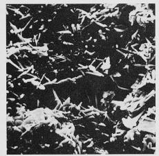
Kristalliner Gefügeaufbau von Hebel-Porenbeton 3900fach vergrössert
