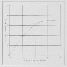
Bild 7. Last-Durchbiegungsdiagramm des Versuchsträgers NV/F2
