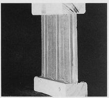
Bild 1. Abschnitt eines Nail-Web-Trägers mit Vollholzgurten und Trapezblechsteg
