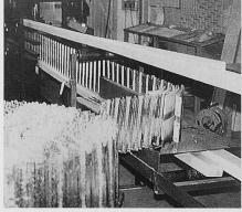
Bild 3. Herstellung eines Nail-Web-Trä-
