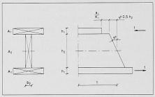
Bild 8. Schematische Darstellung der Verformung eines nachgiebig zusammengesetzten Stegträgers
