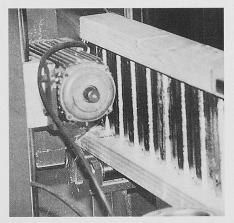
Bild 4. Absägen eines Trägers nach dem Zusammenpressen
