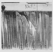
Bild 6. Auflagerbereich des Versuchsträgers NWF2 nach Erreichen der Höchstlast
