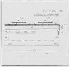
Bild 5. Versuchsanordnung für die Trägerversuche
