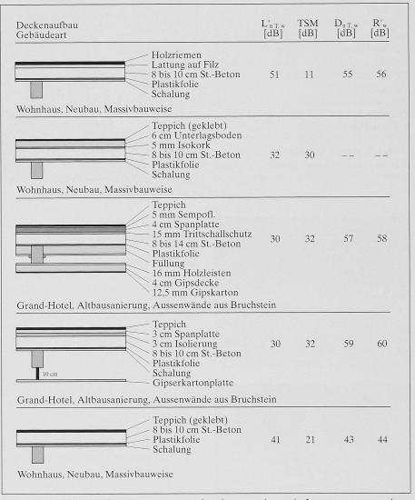
Tabelle 1. Vorliegende Messwerte verschiedener, gebrauchsfertiger HBV-Deckenkonstruktionen. Die Werte  $L'_{nI, w}$  und  $D_{nI, w}$  wurden aus den Messwerten TSM und  $R'_{w}$  errechnet. Sie gelten für übliche Wohnraumabmessungen (Grundfläche  $4.0 \times 5.0 = 20 \text{ m}^2$ , Raumhöhe 2.35 m). Gemäss SIA 181 «Schallschutz im Hochbau» resultieren daraus folgende Raumkorrekturen: B = 1.0 dB, C = 1.0 dB.
